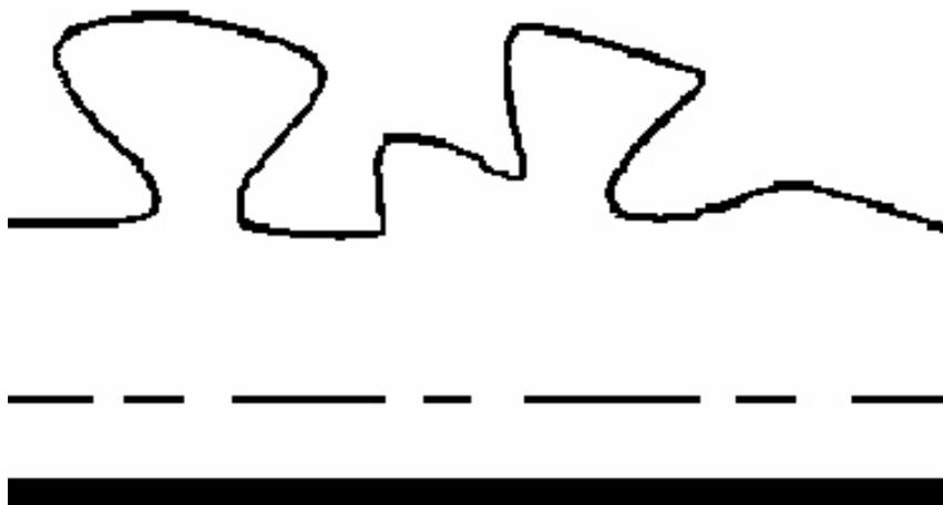
Figura 15: Estrutura da camada limite turbulenta com duas camadas
