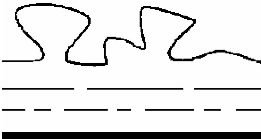
Figura 16: Estrutura da camada limite turbulenta com três camadas
