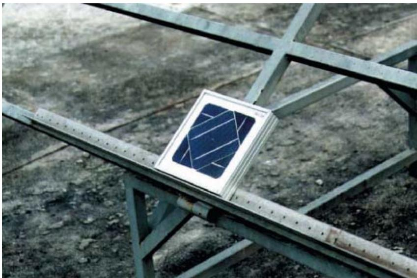
Figura 17 – Piranômetro fotovoltaico (Oliveira, 1997).
