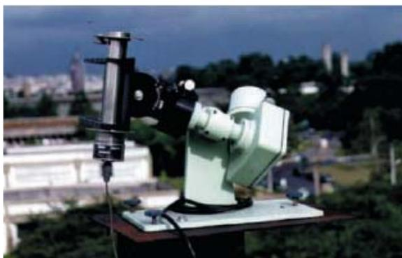
Figura 14 – Piroheliômetro montado em base telescópica (Oliveira, 1997)
