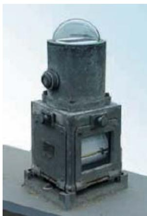
Figura 16 – Piranômetro com elemento bimetálico (Robitzch-Fuess), também conhecido como actinógrafo. (CRESESB, 2003).
