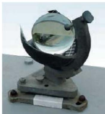
Figura 13 – Heliógrafo de Campbell- Stokes. (Laboratorio de Evaluación Solar, 2006).
