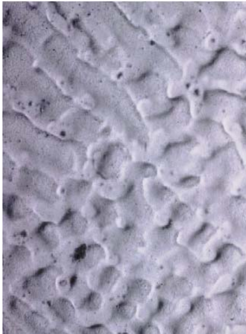
Figura 15 – Microestrutura da liga Litecast, antes da queima para adesão da porcelana, ataque: \text{HNO}_3 e \text{HCL} proporção 1:4, microscopia óptica, 500X. Fonte: Lin et al. , 2008, p.381.
