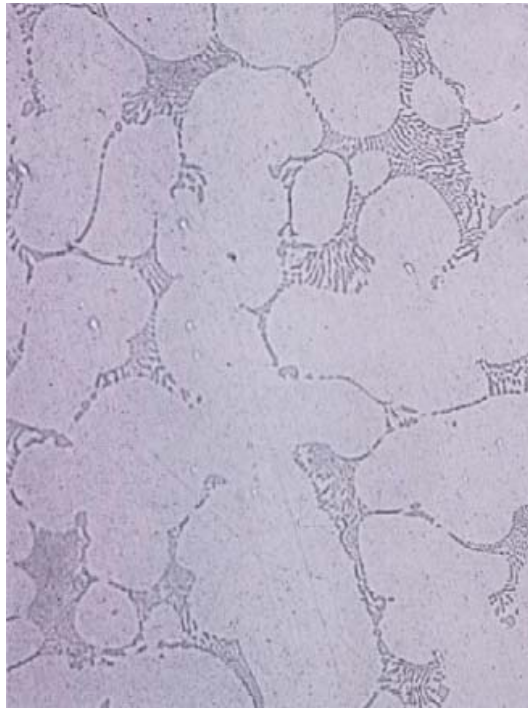
Figura 17 – Microestrutura da liga NPXIII, antes da queima para adesão da porcelana, ataque: eletrolítico em ácido oxálico 10%, microscopia óptica, 500X. Fonte: Lin et al. , 2008, p.381.
