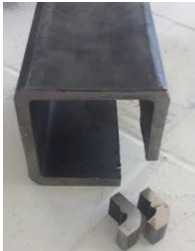
Figura 21 – Obtenção das amostras para caracterização microestrutural.
