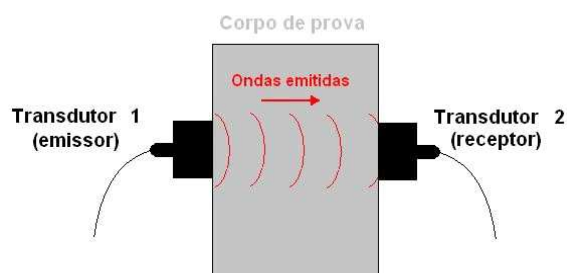
Figura 7: Exemplo de esquema de transdutores sendo utilizados no modo transmissão.
