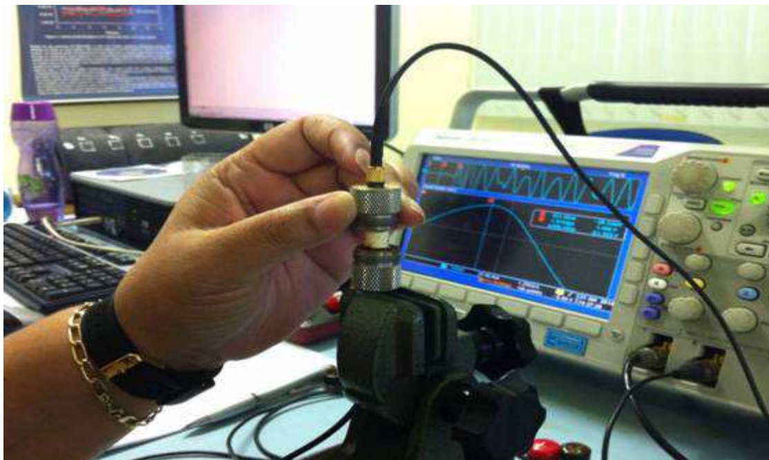
Figura 15: Transdutores de ondas longitudinais, sendo gerado o sinal para a obtenção do tempo de percurso da onda longitudinal na pastilha.
