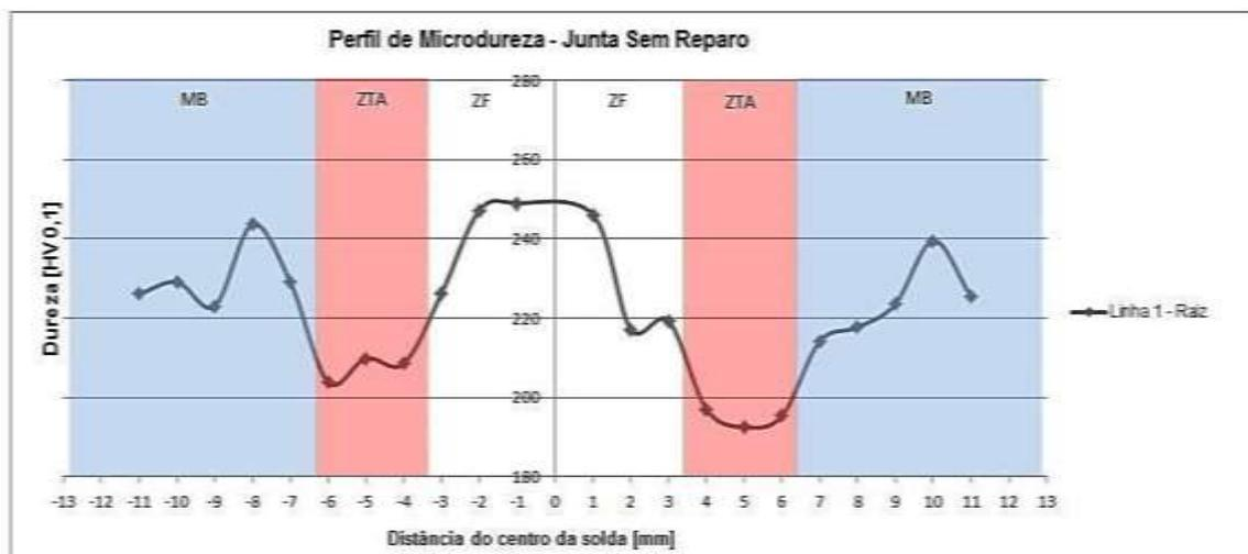
Figura 70. Perfil de microdureza HV da amostra sem reparo na linha 1 (raiz).
