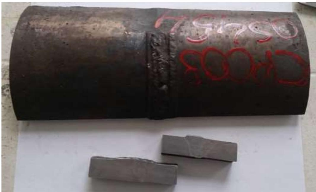
Figura 36. Amostras para análise macro e micrográfica.
