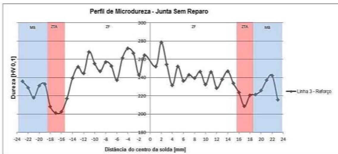
Figura 74. Perfil de microdureza HV da amostra sem reparo na linha 3 (reforço).
