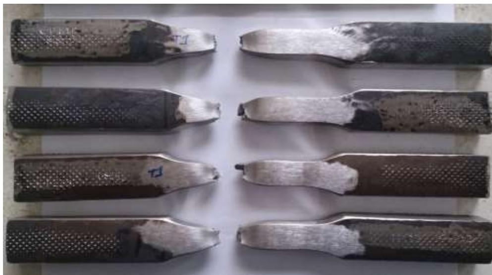
Figura 79. Corpos de prova de tração fraturados.
