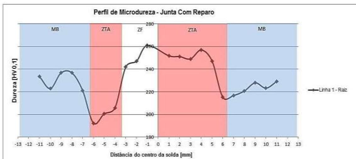
Figura 71. Perfil de microdureza HV da amostra com reparo na linha 1 (raiz).
