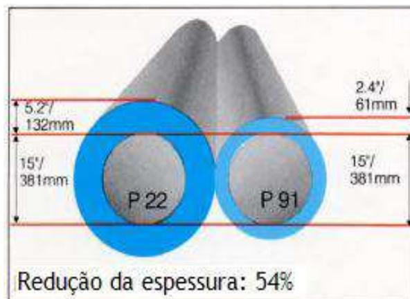
Figura 5. Comparação de espessuras de parede em tubos dos aços P91 e P22 [Adaptado de Newell, 2001].
