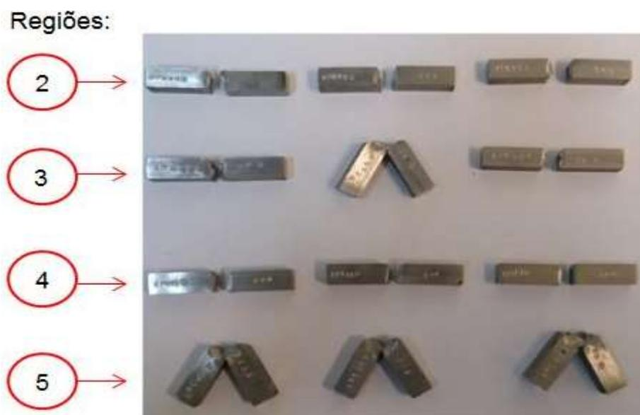
Figura 76. Aspecto dos corpos de prova retirados da junta com reparo após os ensaios de impacto.
