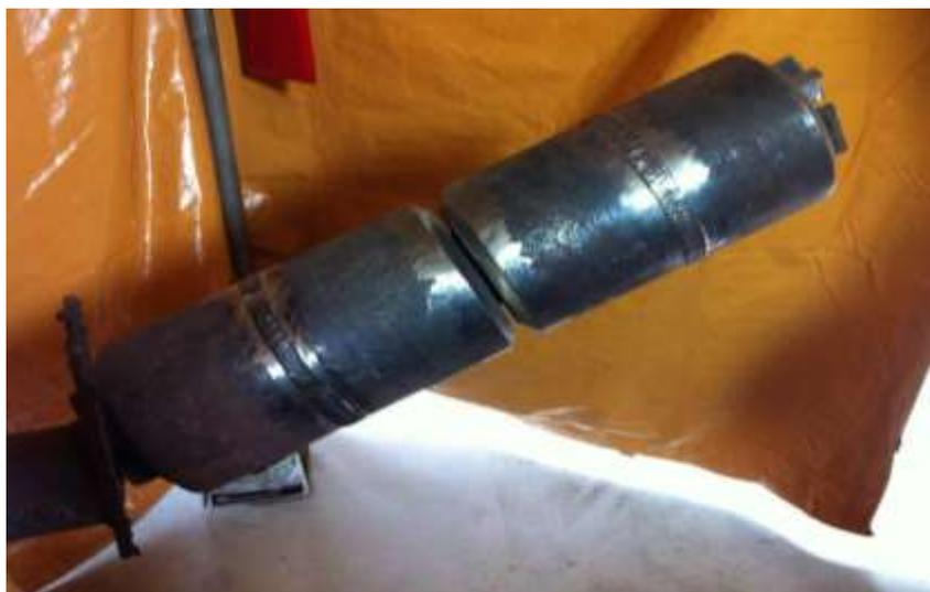
Figura 33. Tubo na posição 6G para soldagem.
