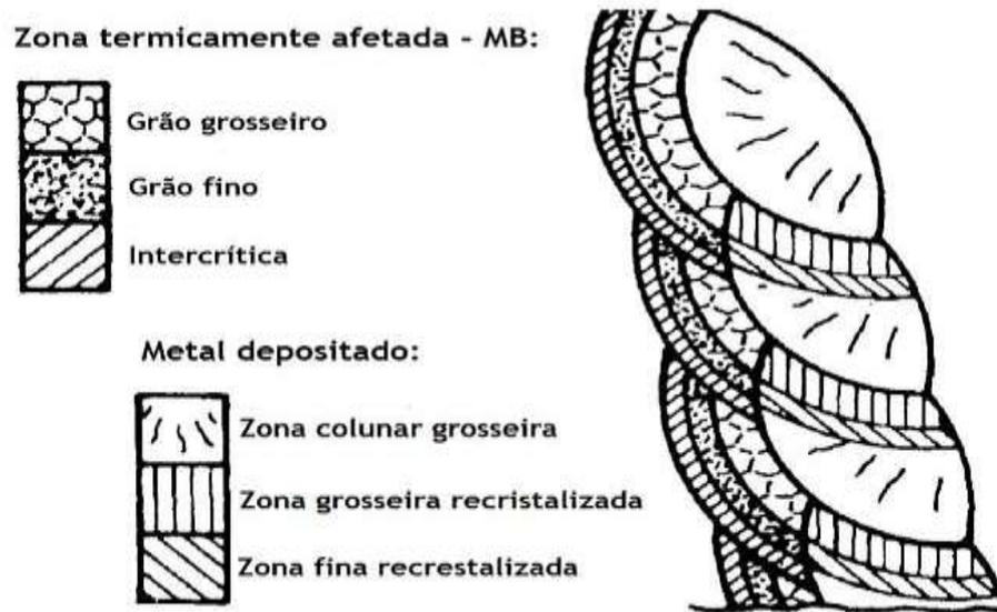
Figura 27. Ilustração da microestrutura após soldagem multipasses [Rocha, 2012].
