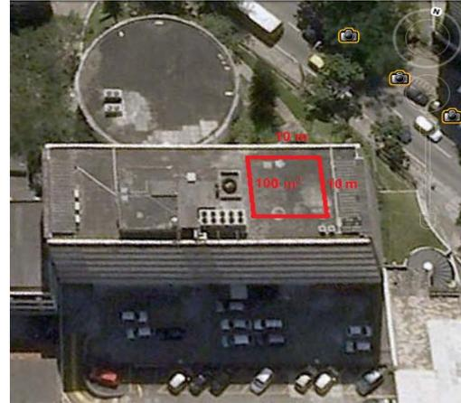
Figura 25 – Vista Superior do Prédio do IBAM. Entorno sem obstáculos que causem sombreamento no telhado. Área possível de instalação do FV.
