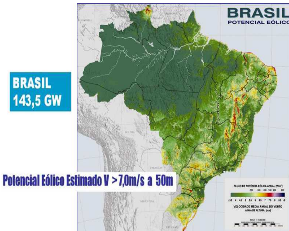
Figura 2.2 - Atlas do potencial eólico brasileiro à 50m de altura Fonte: CRESESB / CEPEL
